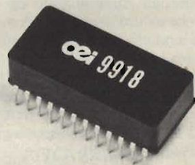
Amplificatore operazionale caratterizzato da un ritardo di propagazione di 5 ns.
