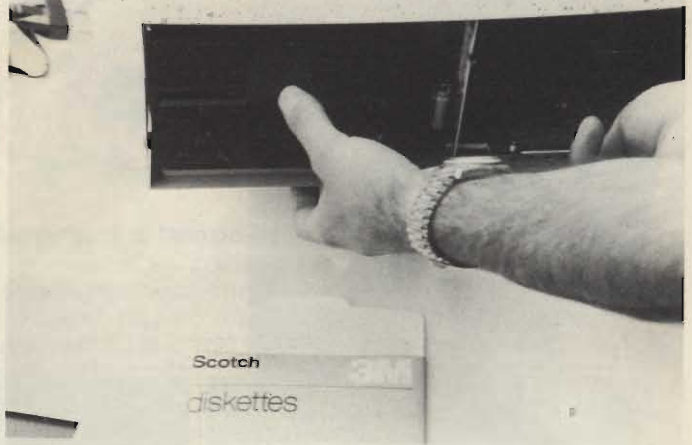
Per ultimo, si serra il bloccaggio tramite la leva del Driver: a questo punto il dischetto è serrato nel Driver ed è pronto a ruotare.
