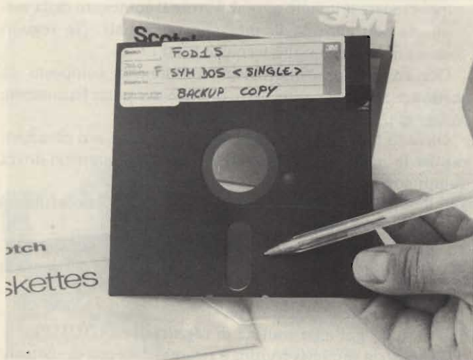
La biro indica la finestrella ovale che permette alla testina di R/W del Driver di appoggiare sul dischetto. Si nota bene la camicia protettiva (più scura) nonché l'etichetta e la banda adesiva nera che, in alto a destra permette di proteggere la scrittura del disco.
