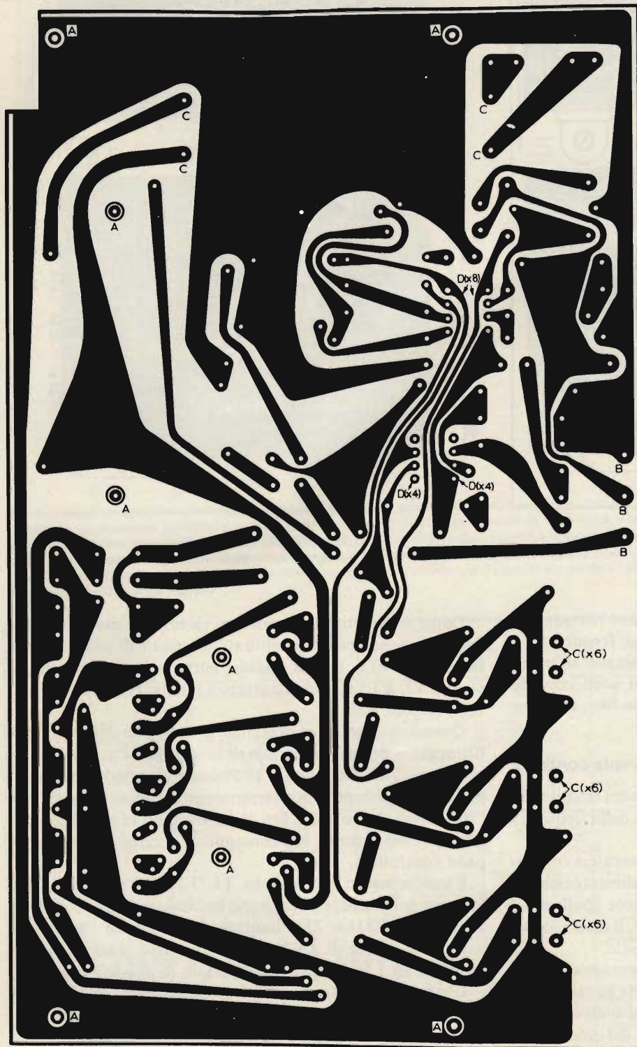
Fig. 9 - Lato rame del circuito stampato che può essere impiegato per entrambe le versioni del dispositivo di cui alla figura 8: la basetta comporta otto fori da 4 mm di diametro (A), tre fori da 1,8 mm (B), 22 fori da 1,3 mm (C) e sedici fori da 0,8 mm (D). Tutti gli altri fori non contrassegnati da lettere devono avere un diametro di 1 mm.
