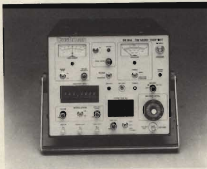
Test set per il collaudo di ricetrasmittenti FM VHF/UHF.
