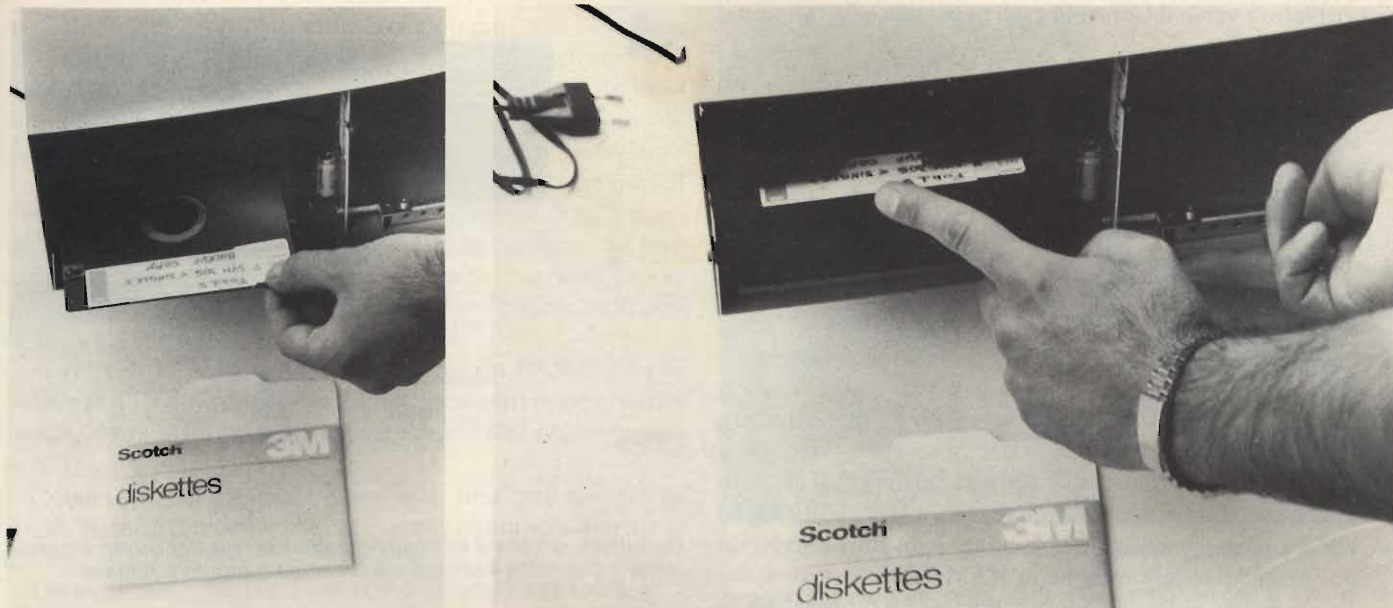
Queste foto mostrano le fasi della inserzione di un dischetto nel Driver da 5"1/4. L'etichetta del dischetto va tenuta verso l'alto. Si nota che il Driver è inscatolato in un contenitore e resta spazio (a destra) per un secondo Driver. Seconda fase della inserzione: con attenzione si spinge il dischetto verso il fondo della fessura del Driver.
